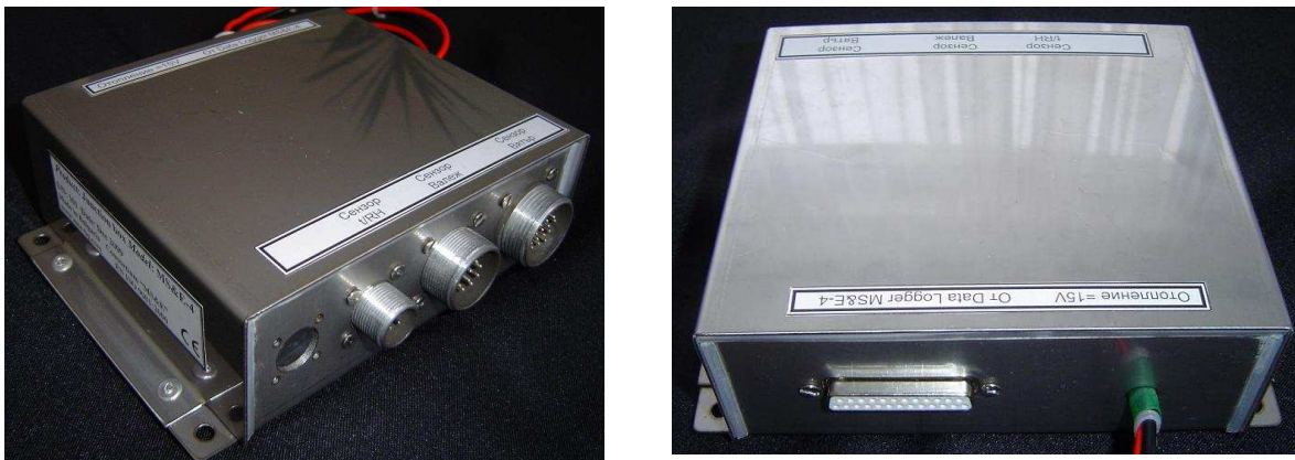
Фиг.2. Външен вид на разпределителна кутия за Data Logger MS&E-4
